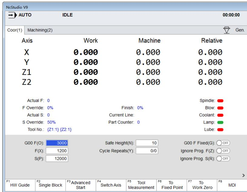
Fig. 4-1 「Coor」 interface under linkage configuration
